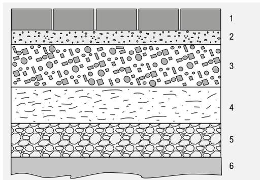
1. 80 mm – betonová tvarovaná (zámková) dlažba vsakovací
