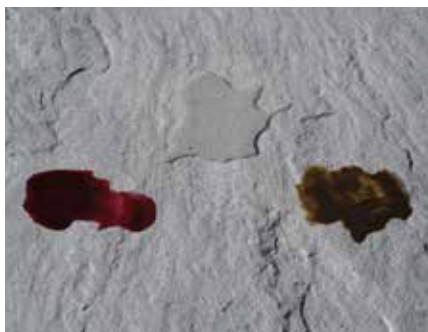
Znečištění – víno, vyjetý olej, voda
