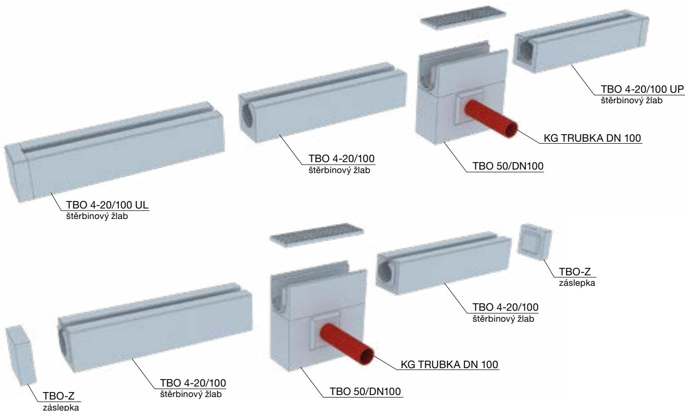
Schématický příklad zabudování žlabů řady TBO 4-20/100.
